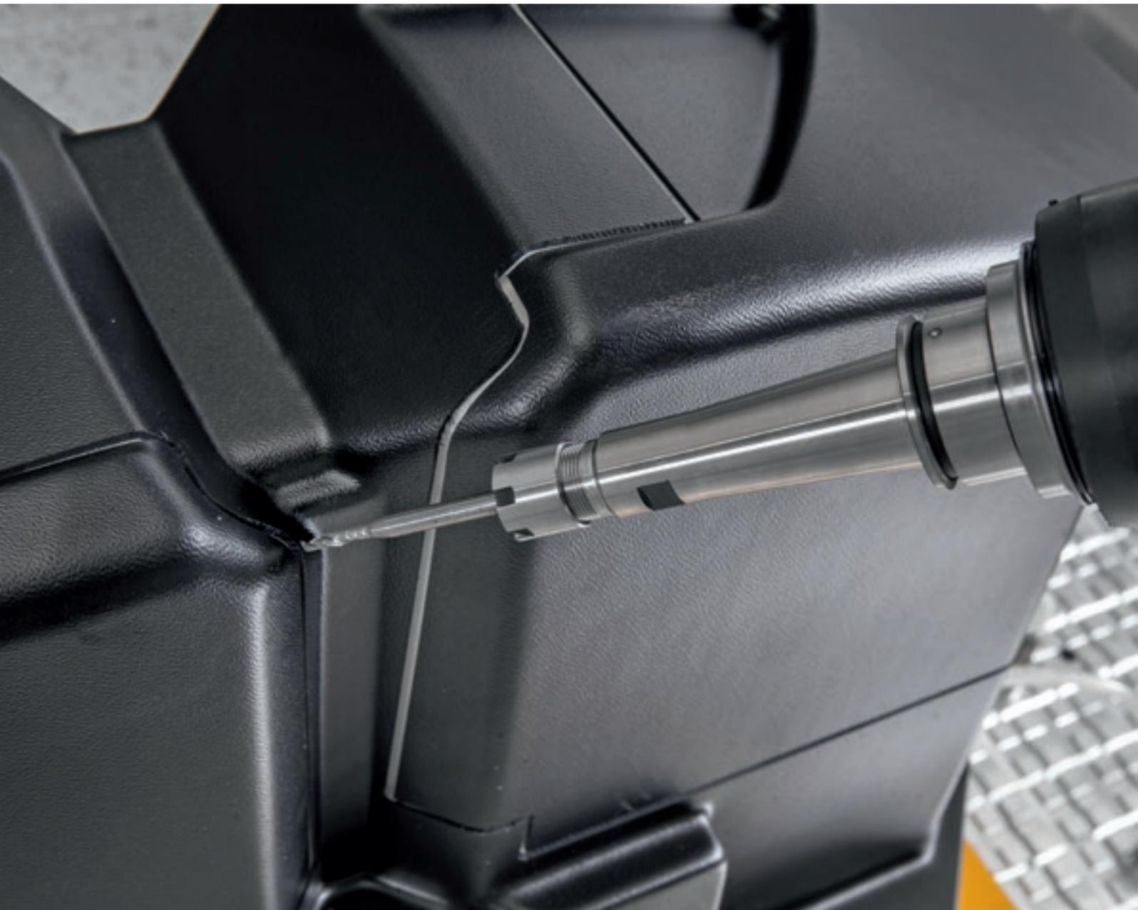
EL CENTRO DE TRABAJO DE PÓRTICO DE ÚLTIMA GENERACIÓN MATERIA CL ES MUY INDICADO PARA EL FRESADO Y EL CORTE DE ELEMENTOS TRIDIMENSIONALES, EN EL SECTOR DE LA AUTOMOCIÓN, AEROSPAECIAL Y NÁUTICO.
