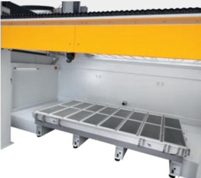
La superficie de la rejilla permite que el operador introduzca la junta dentro de la rejilla en cualquier configuración, creando una zona de vacío.
