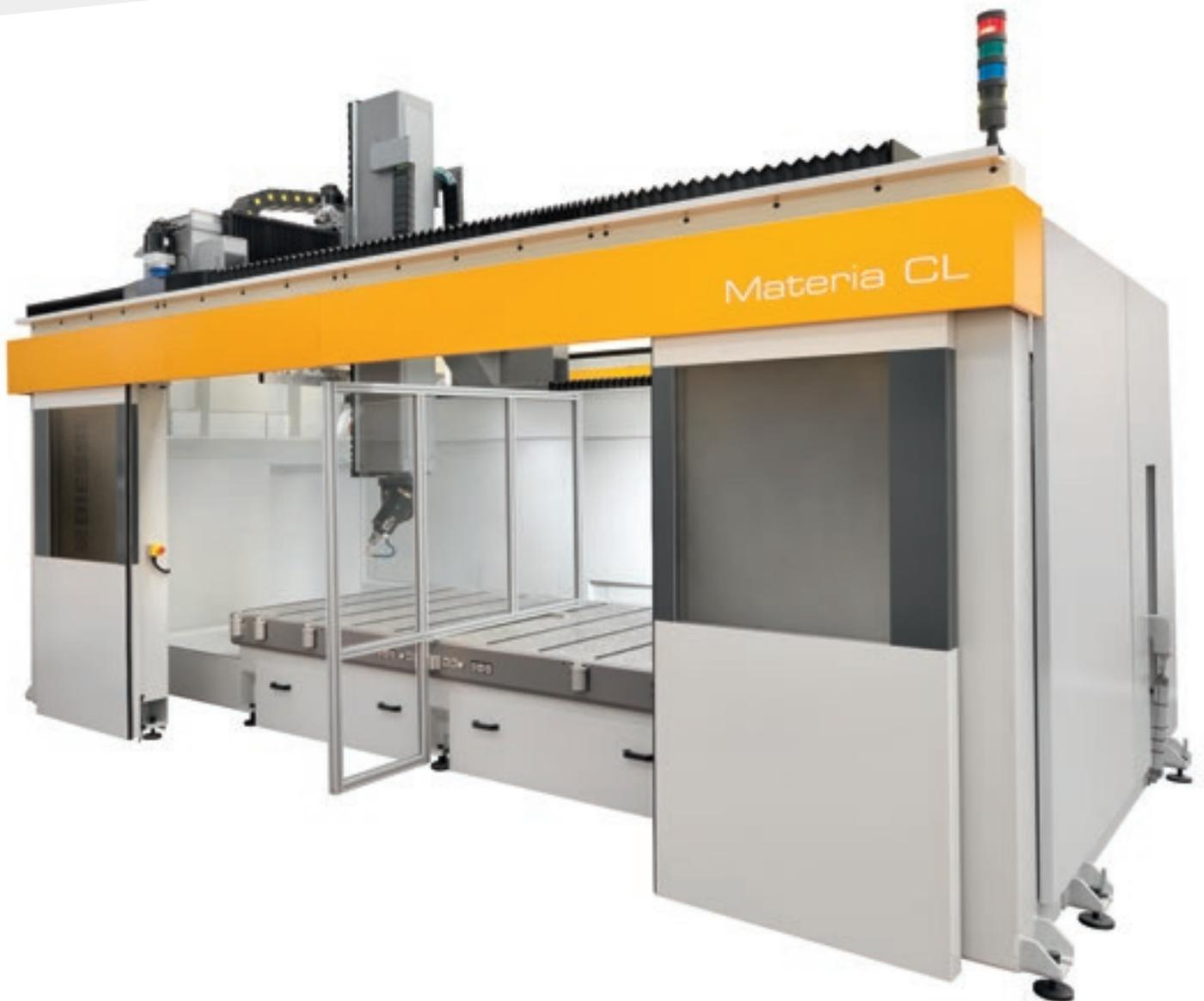
Se puede instalar un tabique desmontable en la zona de trabajo para efectuar el mecanizado pendular.
